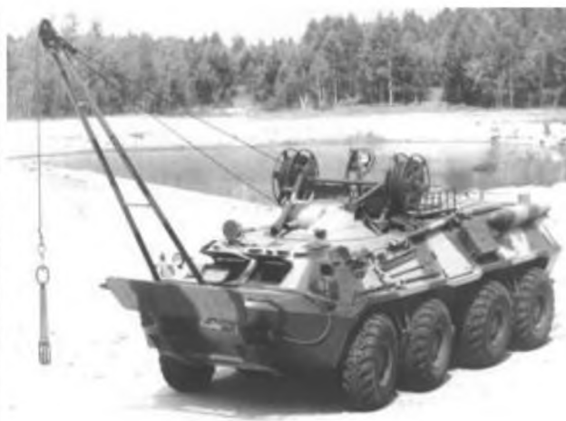
Рисунок 4 – Кран-стрела, установленная на поворотной башне БРЭМ-К
