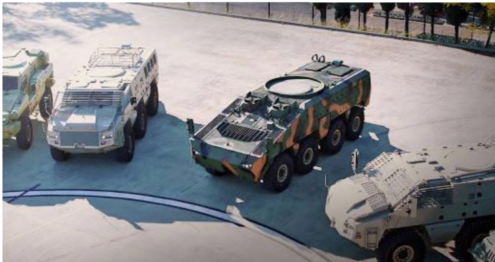
Рисунок 8 – Бронированные колесные шасси высокой проходимости «Барыс» 6x6 (8x8), выпускаемые ТОО «Казахстан Парамант инжиниринг»
