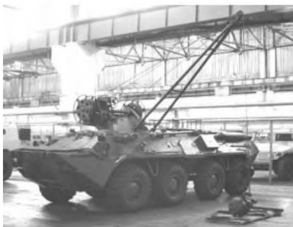
Рисунок 4 – Кран-стрела, установленная на поворотной башне БРЭМ-К
